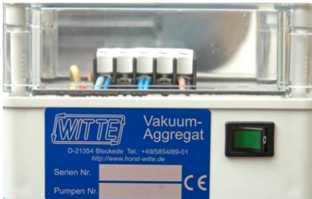
Abb. 7: Schaltgehäuse mit Hauptschalter
