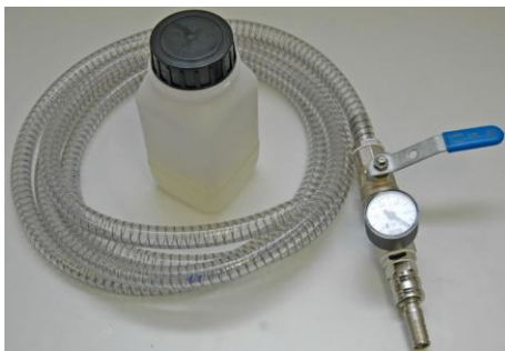
Abb. 11: Vakuumsaugschlauch und Kompressorenöl
